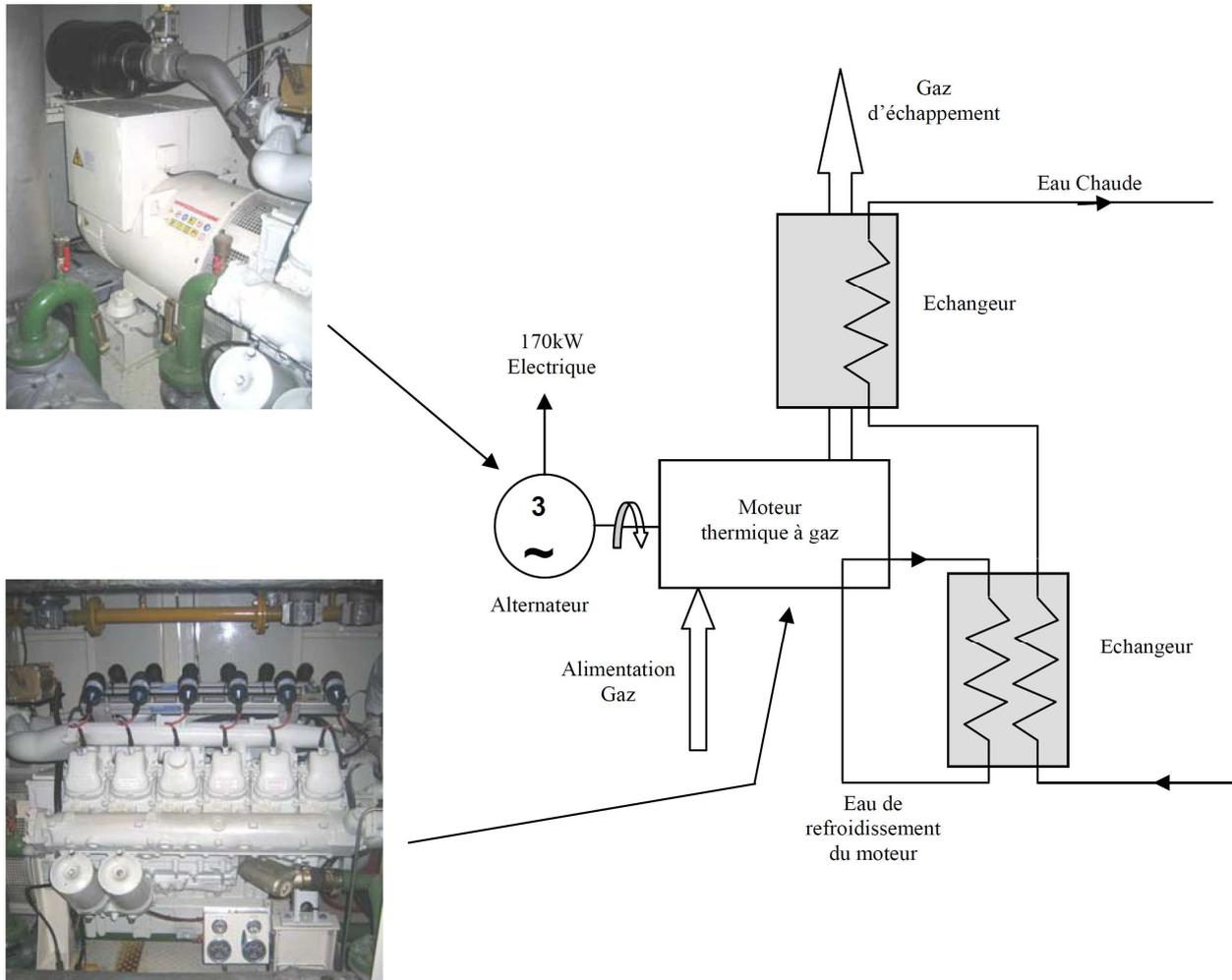
QUESTION n°12 : Pour quantifier l'échange de calories entre le circuit d'eau chaude et les récupérateurs d'énergie thermique montés sur le moteur, il vous est demandé de calculer la variation de température notée,  $\Delta \square$  dans le circuit d'eau chaude sachant que le débit est de 24,9 m<sup>3</sup>/h, si on considère **Pth1 = 185 kW** et **Pth2 = 110kW** (voir formule DT A2).
